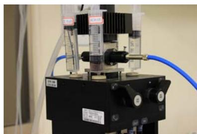
Fig 3-65 (a)將所有閘門鈕向上扳 (b)樣品由注射口吐回到針筒中，再回收。
