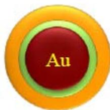
圖 3-24 金核-銀殼型奈米粒子示意圖
