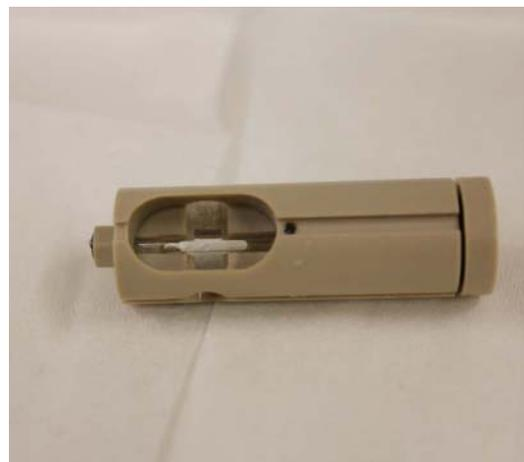
Fig.1-4 Cuvette 近照。
