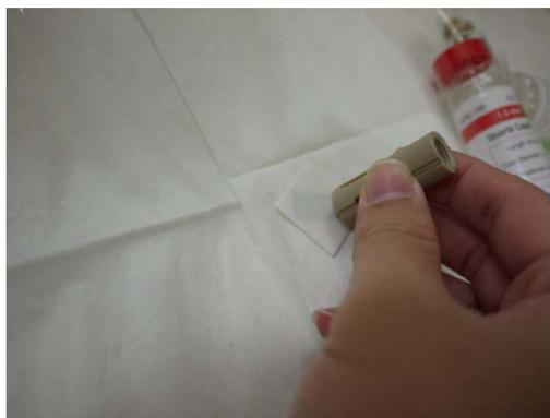
Fig.1-14 於刀片空白面輕放細磨。
