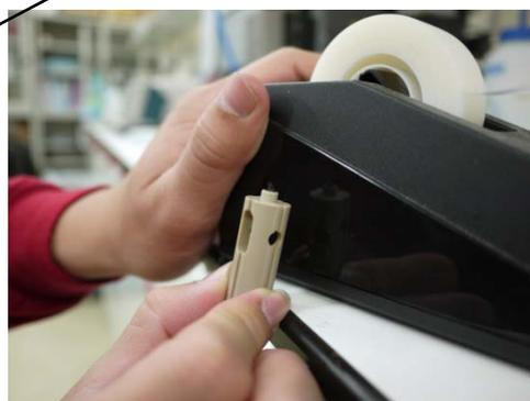
Fig.1-12 刀片輕靠毛細管，轉動 Cuvette。 Fig.1-13 切斷後，如圖管口需平整。
