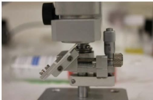
Fig.1-10 以刀片削斷下端毛細管
