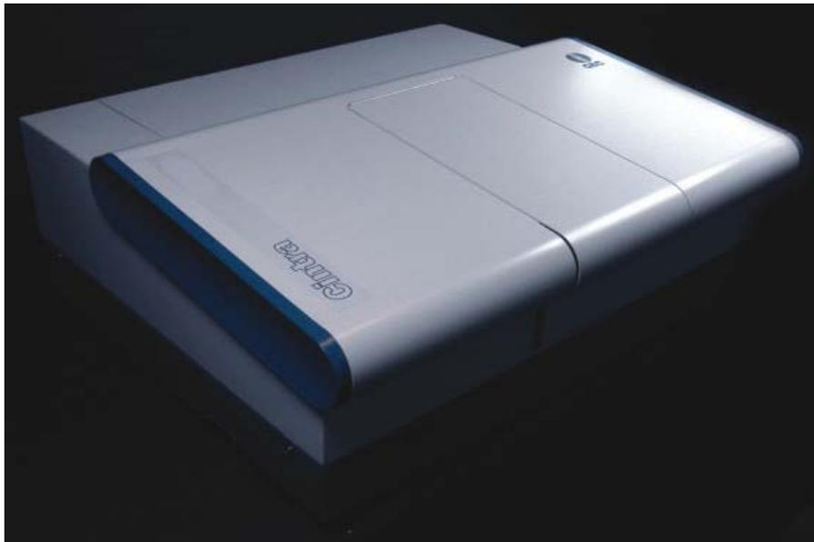
圖 2- 13 GBC Cintra 202 UV-Vis Spectroscopy
