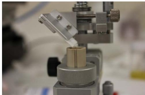
Fig.1-11 削斷上方毛細管
