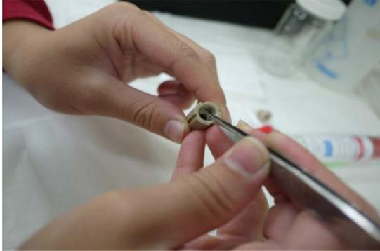
Fig.1-15 延毛細管壁夾碎。
