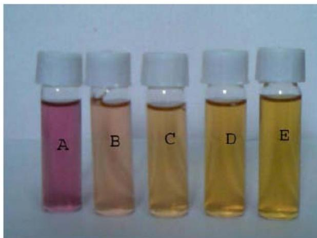
圖 1-17 (A)為金奈米粒子 (B ~ E)銀離子加入量逐漸增加生成的 Au@Ag 奈米粒子
