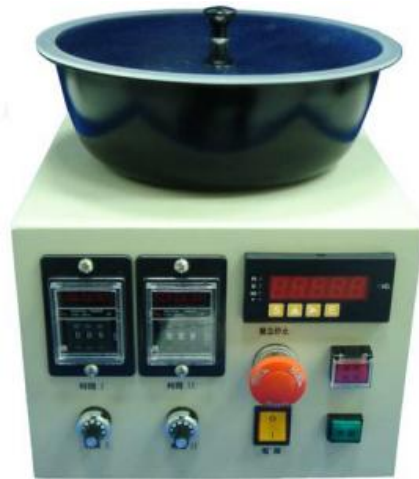
圖 3-20 兩段轉速控制的旋轉塗佈機（東海大學化學系）。
