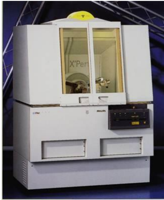
圖 2-24 X光繞射儀外觀。(東海大學共同貴重儀器中心)
