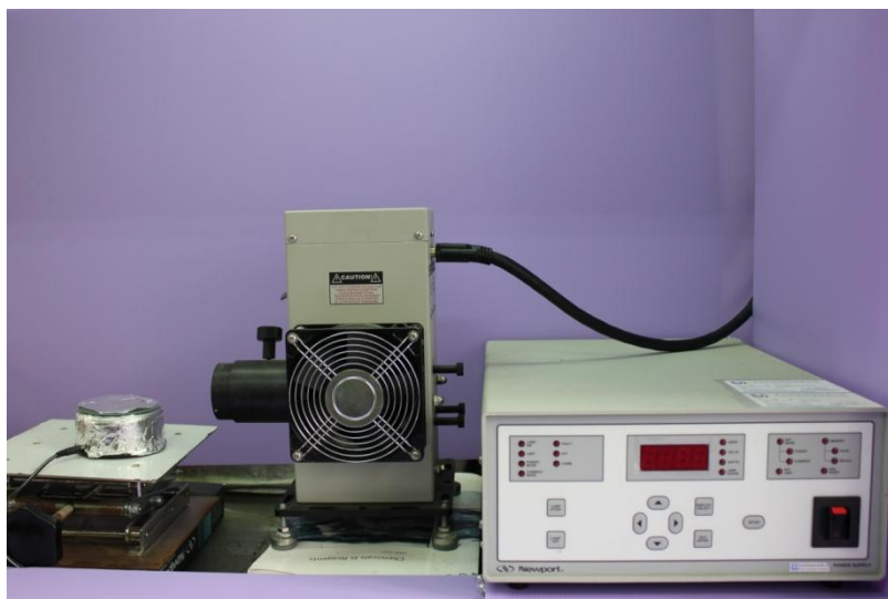
圖 2-19 高壓汞燈儀器之外觀。
