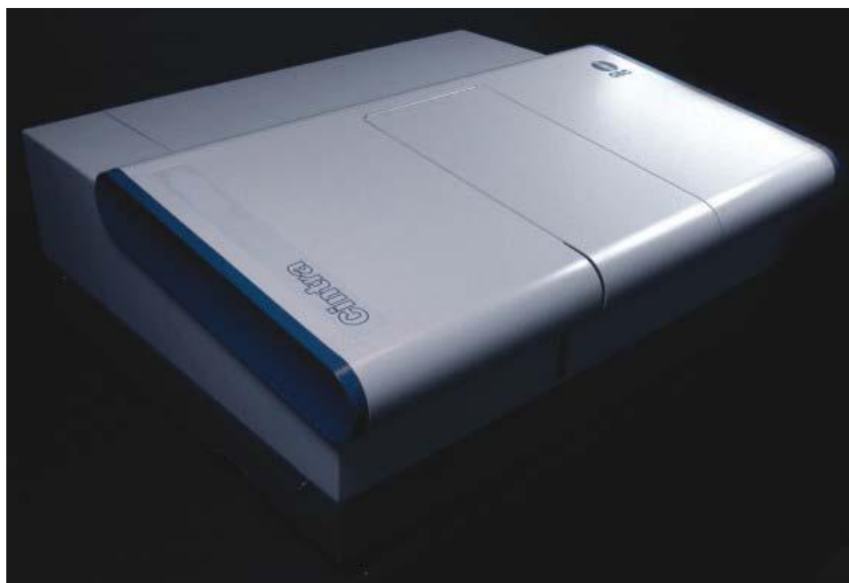
圖 2-6 GBC Cintra 202 UV-Vis Spectroscop。
