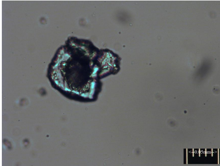
圖4-5 61 \mu mPMMA的OM圖(200倍)
