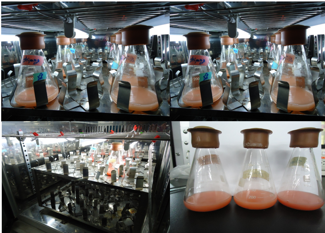
圖 3-6 提供光源下之搖瓶培養裝置圖
