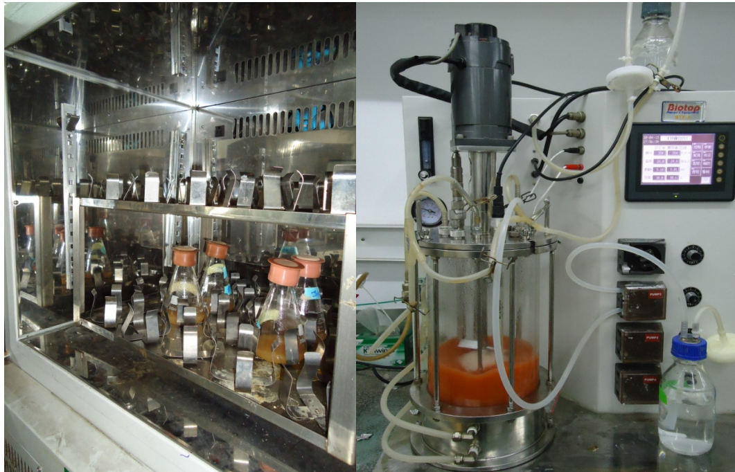
圖 2-3 左: Rhodotorula glutinis 之搖瓶批次培養裝置圖；右: Rhodotorula glutinis 之 5L 發酵槽批次培養裝置圖
