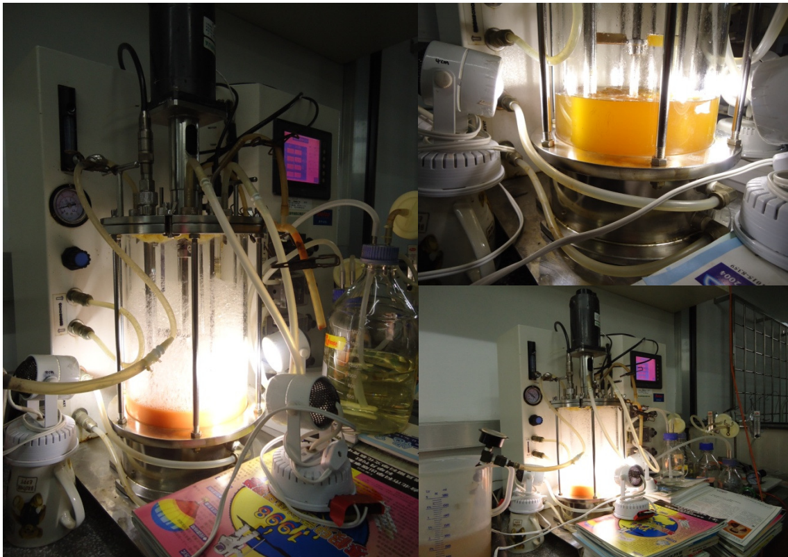
圖 3-8 提供三盞 LED 光源下之連續饋料批次發酵裝置圖
