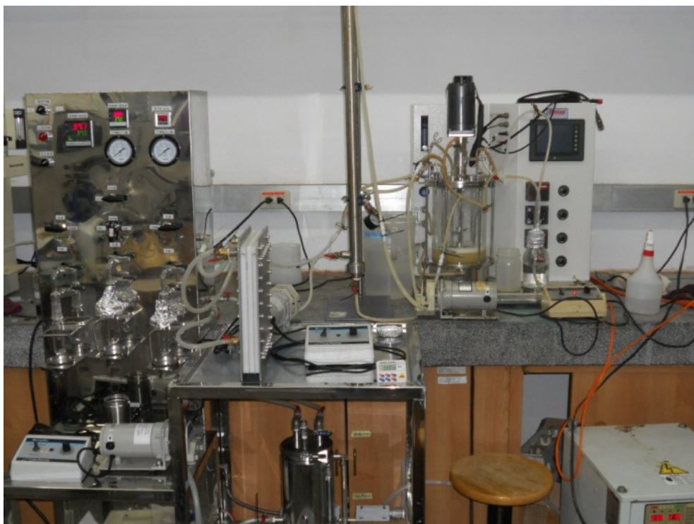
圖 4-16 應用陶瓷過濾模組以及滲透蒸發系統於 5-L 發酵槽之操作情形
