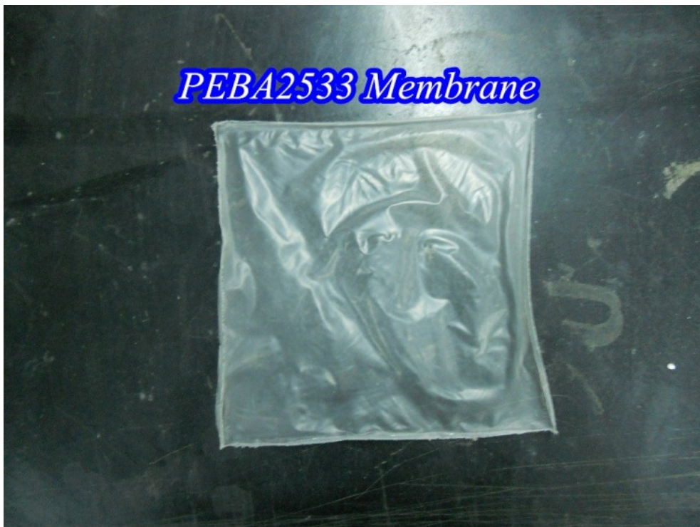
圖 3-3 利用 PEBA 製作出來之滲透蒸發薄膜
