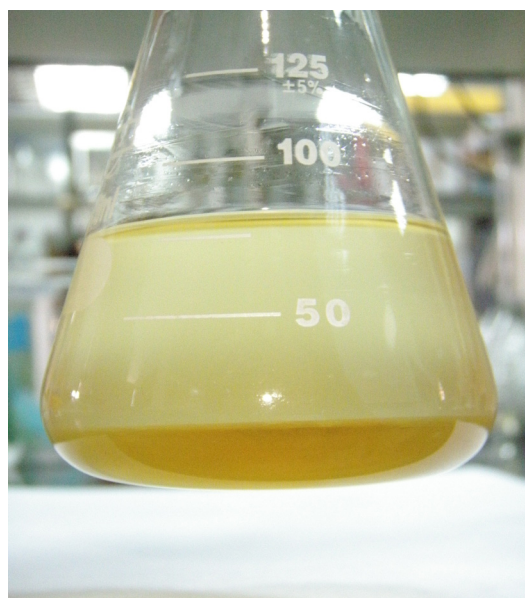
圖 4-16 鹼催化轉酯化反應後的情況
