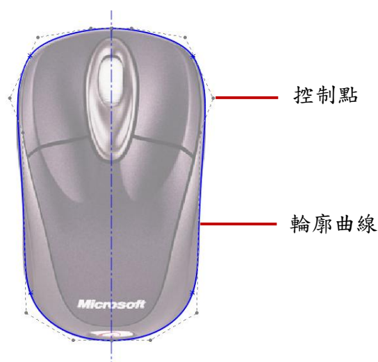
圖 3-6: Solidworks 描繪的輪廓與所得的 B-Spline 控制點
