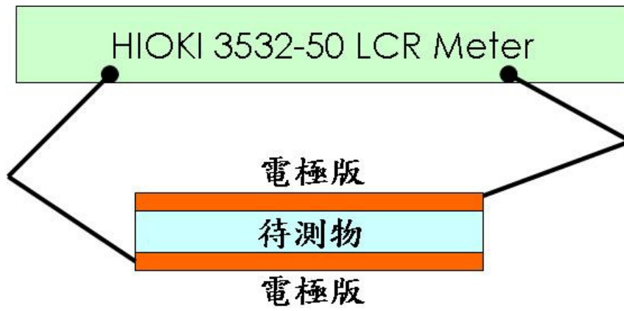
圖 3-3 低頻介電量測系統
