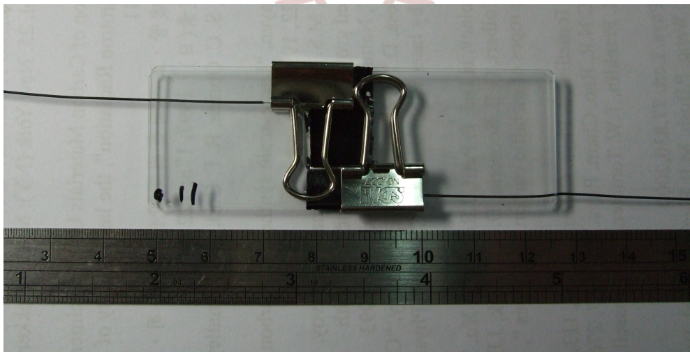
圖 3-4 電容組裝完成實體模型
