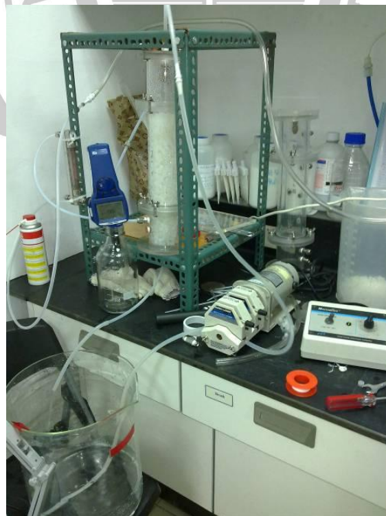
圖 3-3 實際洗滌設備裝置圖
