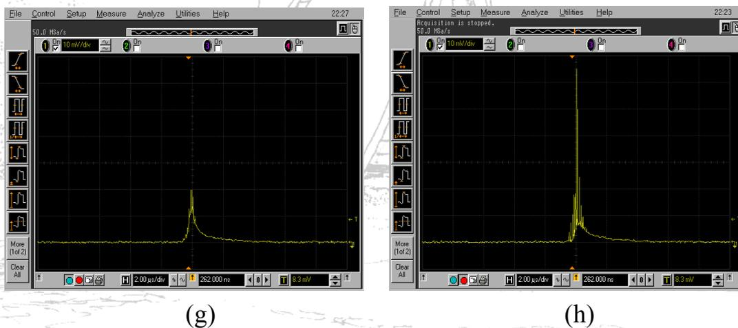
圖 4-10 比較有加聲光鎖模與沒加聲光鎖模的被動 Q 開關(Cr:YAG)
