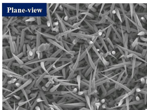
圖4-2 射頻功率60瓦之樣品SEM圖
