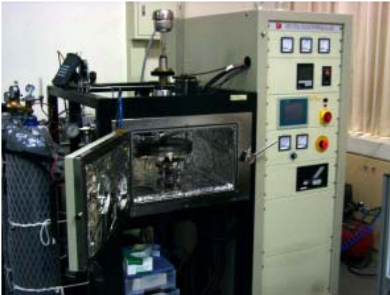
圖一.本實驗室自行設計之奈米雷射製程真空腔
