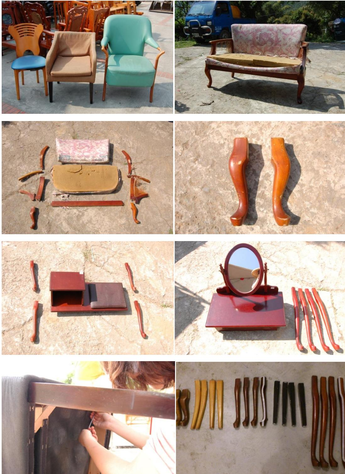
圖 3.8 椅腳拆卸過程圖
