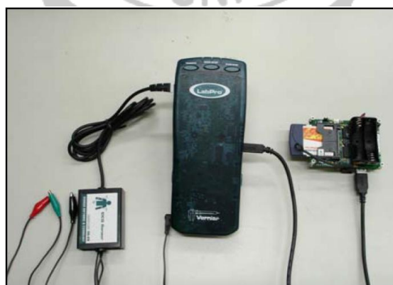
圖 3.3 EKG Sensor 連接 Mote Sensor 設備
