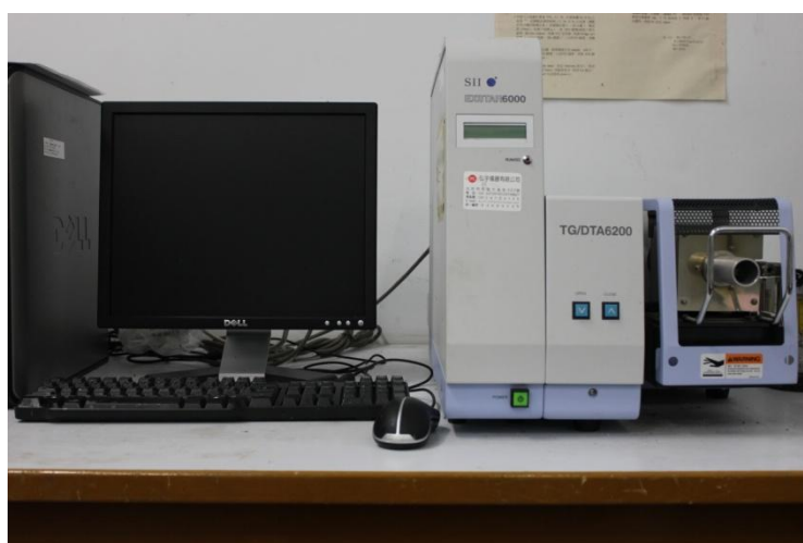
圖2. 5 Exstar 6000 TG/DTA 6200 熱重分析儀
