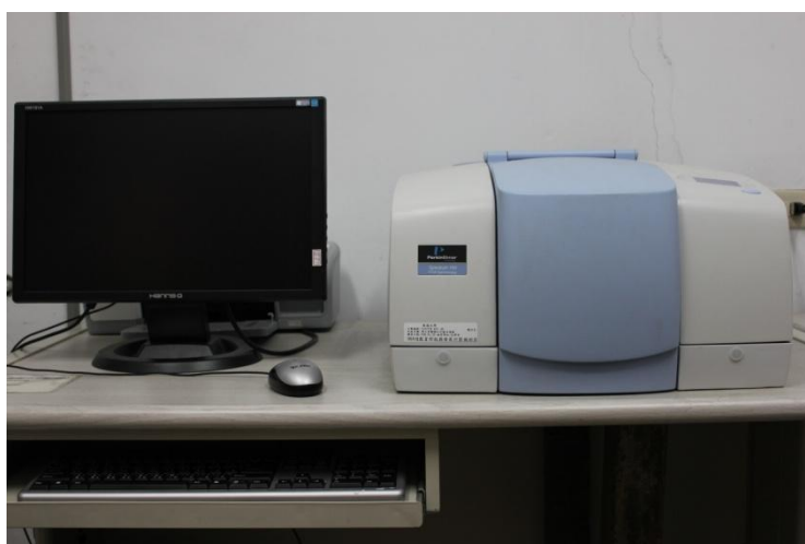
圖 2.3 Perkin-Elmer 100 傅立葉轉換紅外線光譜儀
