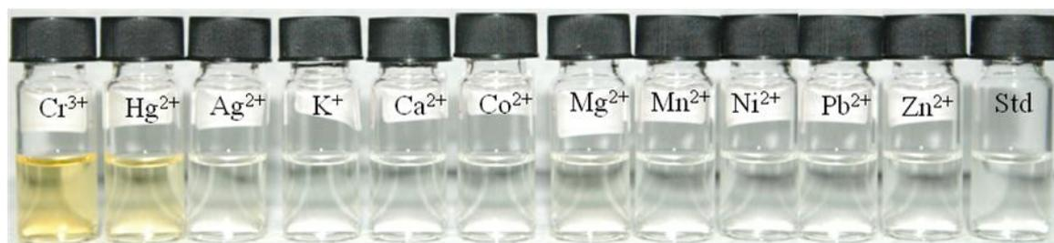
圖 4-12 化合物(II) ( $4 \times 10^{-5}$  M) 溶於含有 90%  $\text{CH}_3\text{CN}/\text{H}_2\text{O}$  (v/v) 溶液中對各金屬離子在 2 當量之顏色變化。
