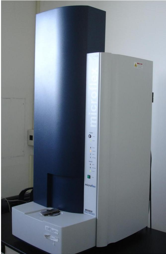
**【圖四】**桌上型 Micro-flex 基質輔助雷射脫附游離飛行時間質譜儀。
