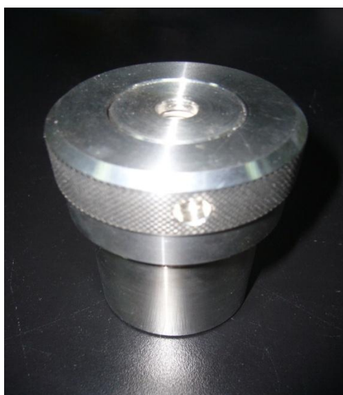
圖 1-2 不鏽鋼材質的高溫高壓反應器
