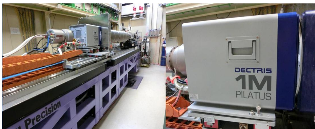
圖 3- 7 國家同步輻射研究中心(NSRRC)BL23A 小角度 X 光散射儀
