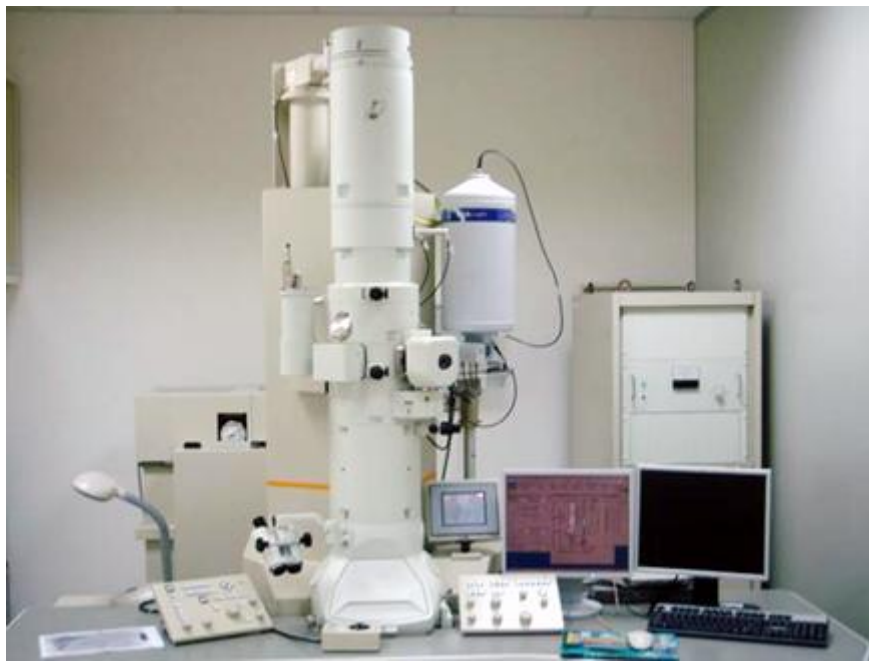
圖 3.2 中興大學穿透式電子顯微鏡 型號：JEM-1400(上) 與 東海大學高解析度穿透式電子顯微鏡 型號： JEM-2100(下)。
