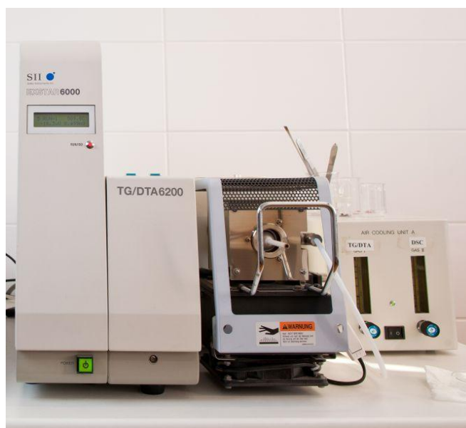
圖 3.3 熱重分析儀，廠牌：Exstar 6000 ，型號：TG/DTA
