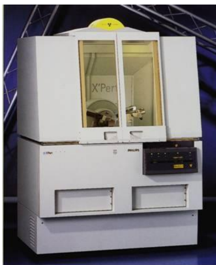
圖 3.4 東海大學 X 光繞射光譜儀，型號： X'pert Pro MPD。
