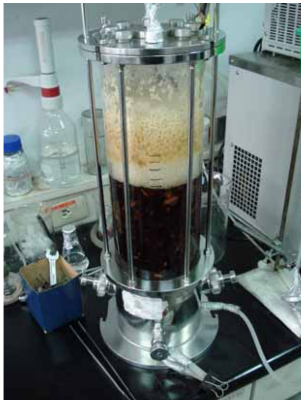
圖 4-27 泡柱式發酵槽通氣量 0.5 vvm 發酵液中懸浮菌體之外觀。
