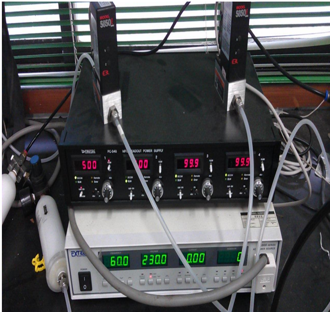
圖十二，電漿供電系統及氣體流量控制儀。
