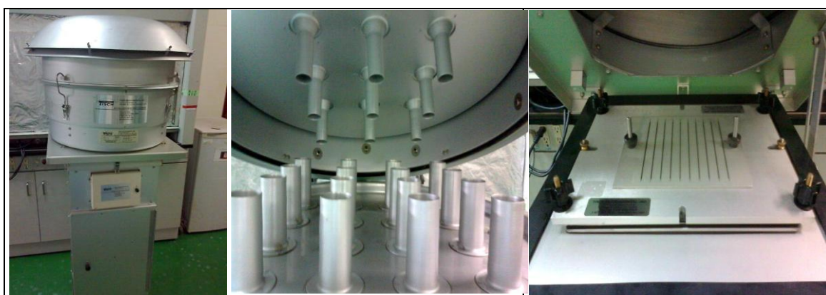
圖 3-2.5 Tisch TE-6070D 採樣器外觀及內部構造
