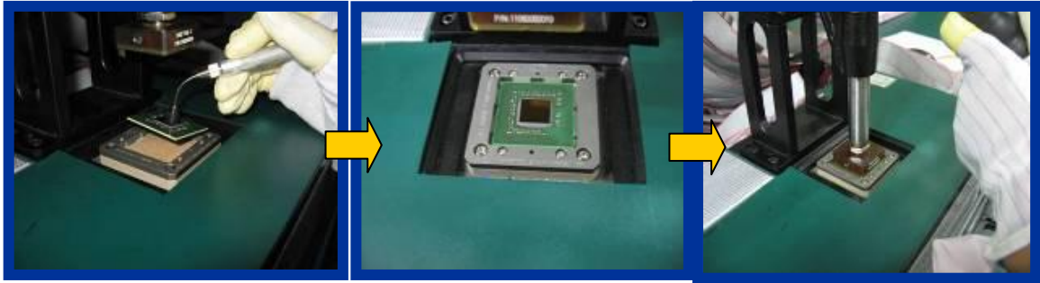
圖 十七 電性測試站作業示意圖
