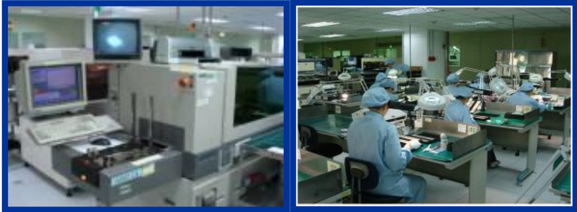
圖 十八 腳平面度及最終外觀檢驗站作業示意圖
