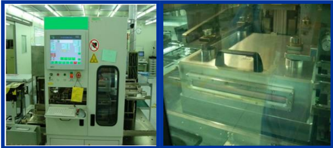
圖 十二 電漿清洗站作業示意圖
