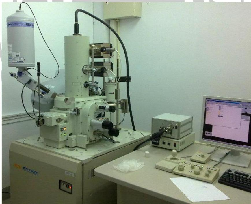
圖 3.7 掃描式電子顯微鏡(JEOL JSM-7000F)
