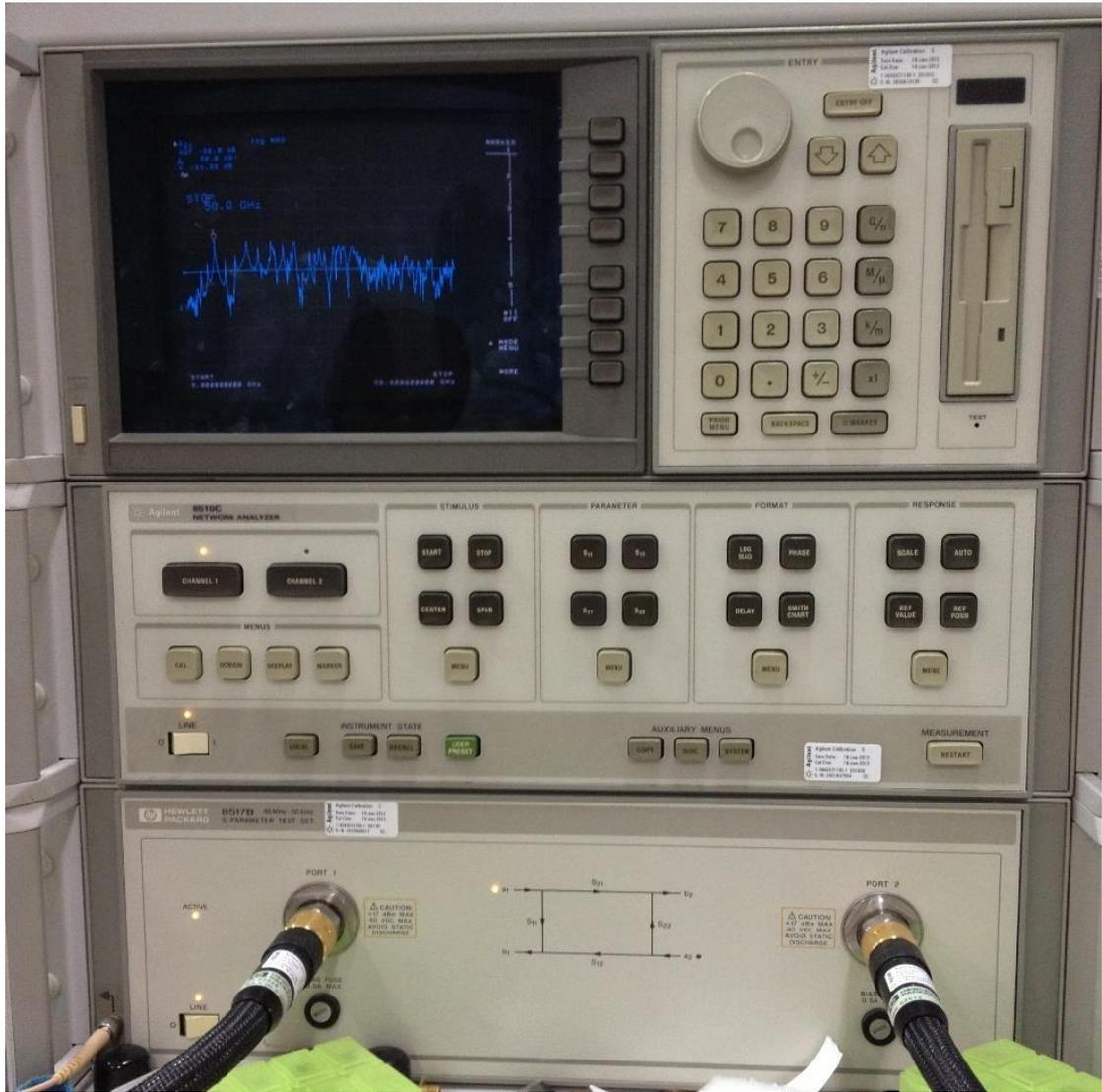
圖 3.10 網路分析儀(Agilent 8510C network analyzer)
