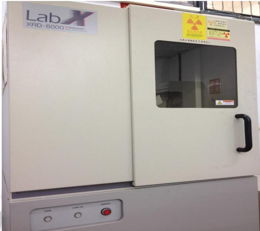
圖 3.6 X-ray 繞射分析儀(Shimadzu 6000)
