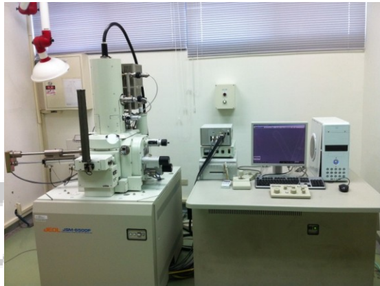
圖 2 - 12 SEM 儀器裝置圖。
