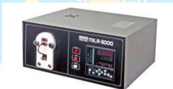
圖 3-1-3 型號 : MILA 3000 快速升溫退火爐 (RTA)
