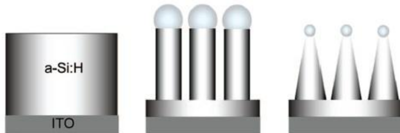
圖1-4 由左至右分別是矽薄膜、圓柱狀矽奈米柱、錐狀矽奈米柱
