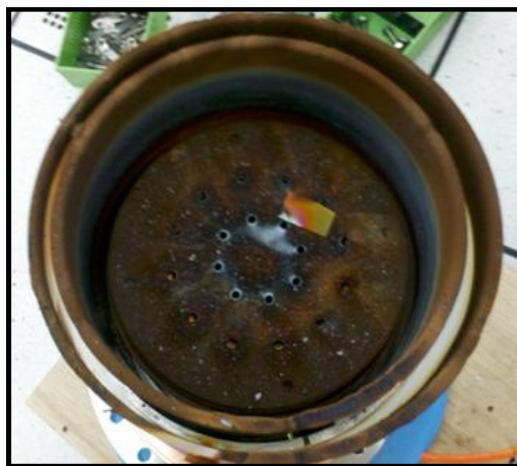
圖4-5、製程後粉塵堆積於氣導流板示意圖
