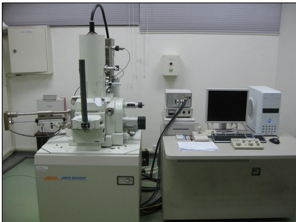
圖4-21、熱場發射掃描式電子顯微鏡
