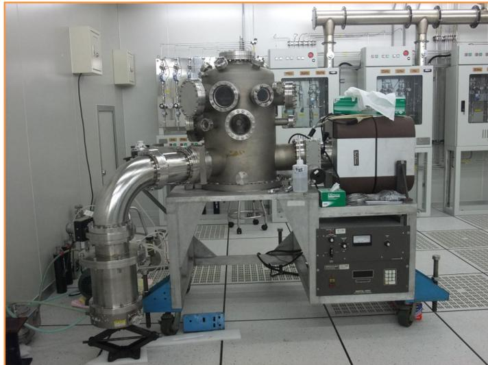
圖4-1、尚未加裝樣品傳輸裝置之電漿化學氣相沉積系統
