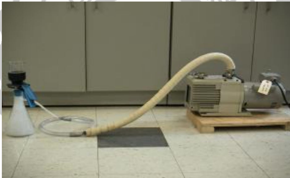
圖 2.18 機械 PUMP 過濾裝置
