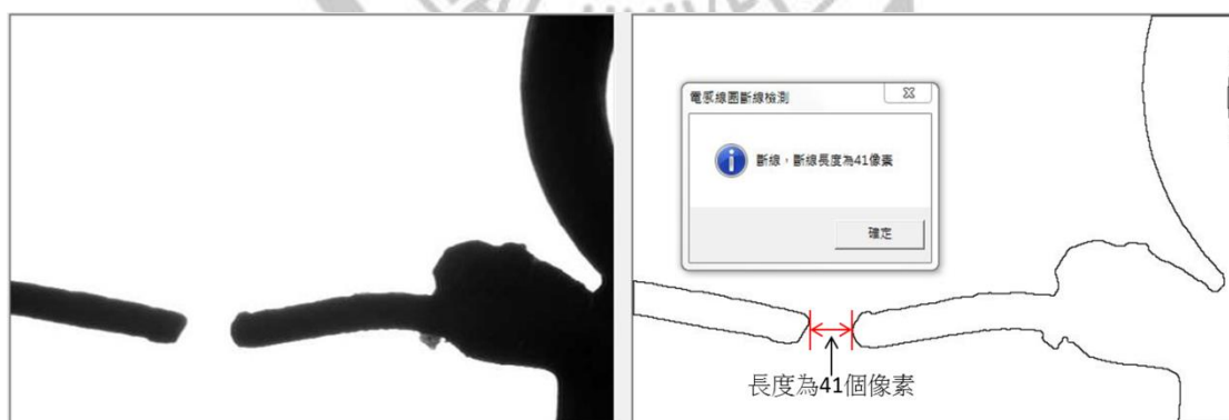
圖 4-17 電感線圈檢測結果為斷線，斷線長度 41 個像素
