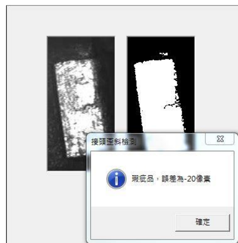
圖 4-12 歪斜檢測結果為瑕疵品，誤差為 20 個像素
