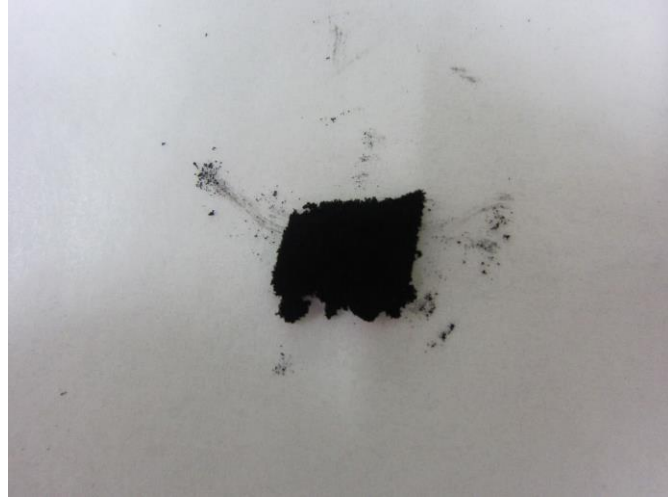
圖 3-11 氫氣、30 瓦、15 分鐘之奈米碳管
