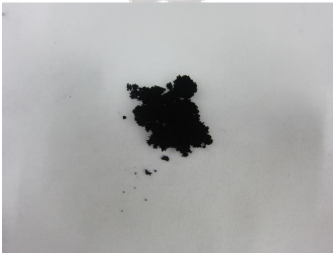
圖 3-13 氮氣、30 瓦、15 分鐘之奈米碳管
