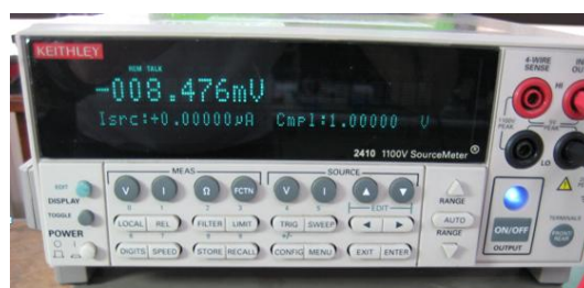
圖 3.26 Keithley Model 2410 Meter
