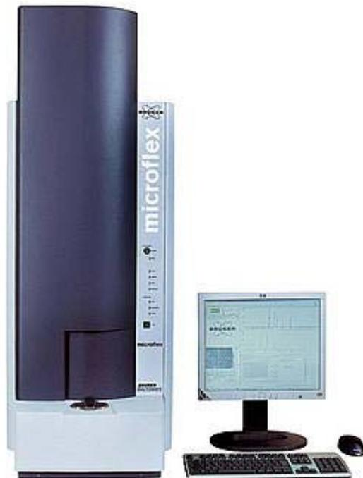
圖七、MALDI-TOF MS 之儀器照片圖
