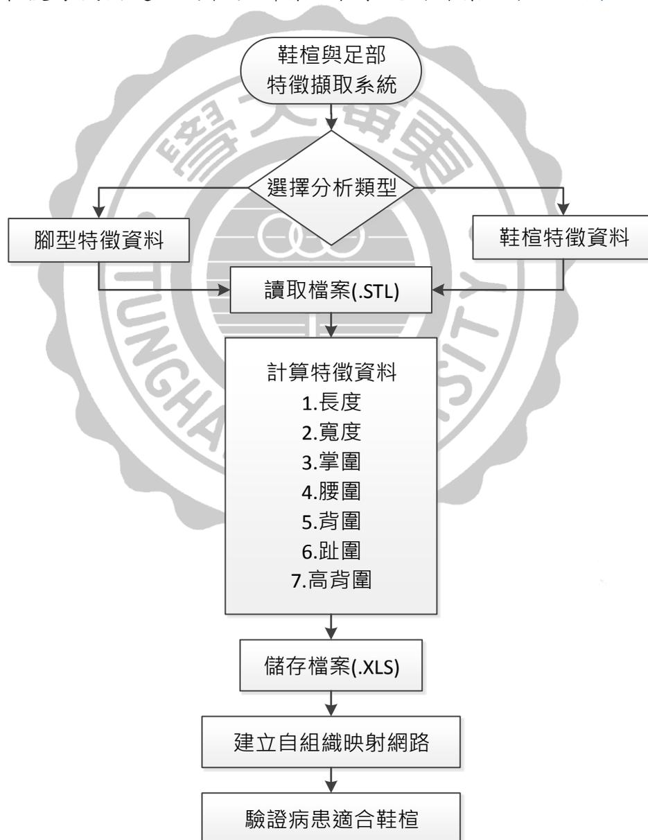
圖 27 研究系統作業流程
