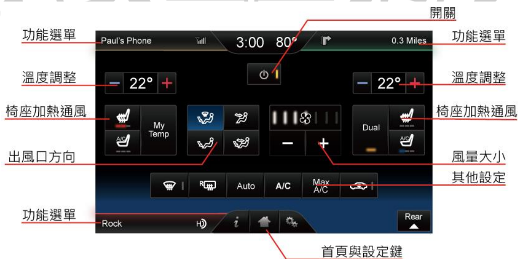
圖 3-6 MyFord Touch 空調控制細部配置說明
