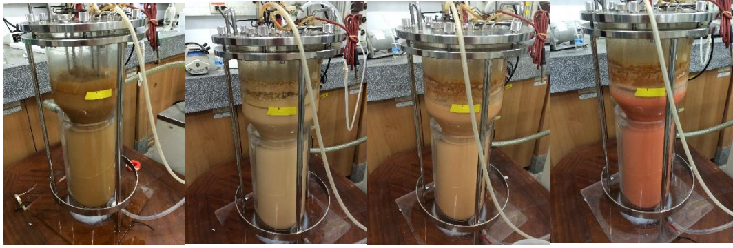
圖 4-26 5 L 氣舉式發酵槽， R. glutinis 在全海水培養基下培養 183 hr 之變化情形
