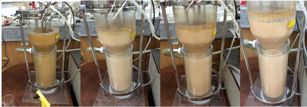
圖 4-11 5 L 氣舉式發酵槽， R. glutinis 在 pH 5.5 且不滅菌下培養 63 hr 之變化情形
