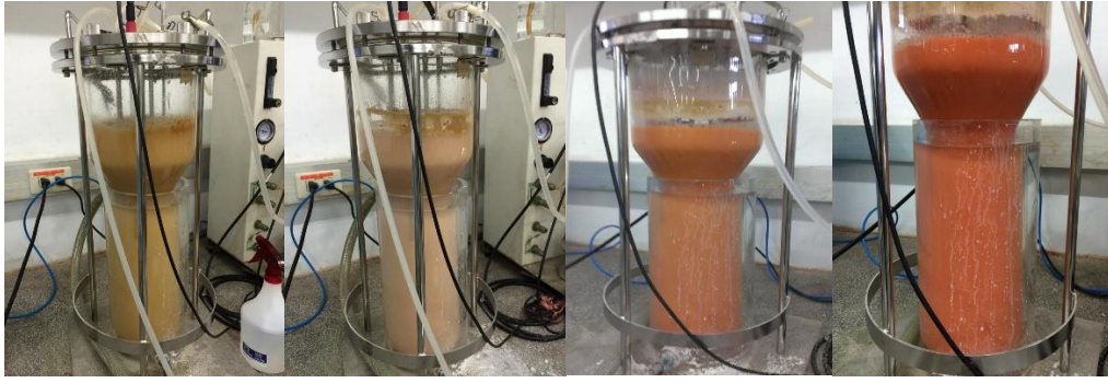
圖 4-34 5 L 氣舉式發酵槽， R. glutinis 在添加界面活性劑 5 g/L 下培養 159 hr 之變化情形
