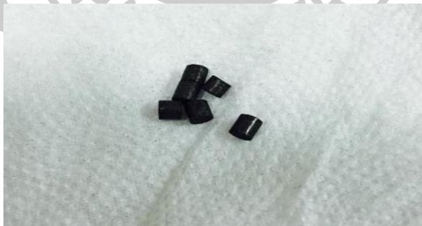
圖 3-1  $\text{CuCr}_2\text{O}_4$  觸媒顆粒大小
