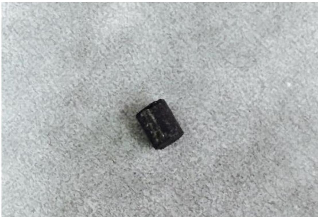
圖 4-52 反應後  $\text{CuCr}_2\text{O}_4$  觸媒
