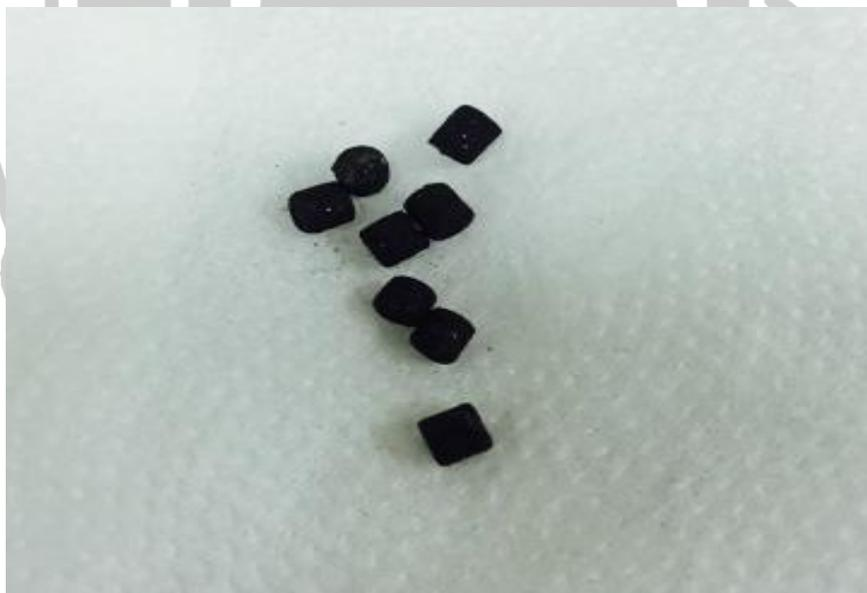
圖 3-3  $\text{CuCr}_2\text{O}_4\text{-Pd}(100\text{:1})$ 觸媒顆粒大小
