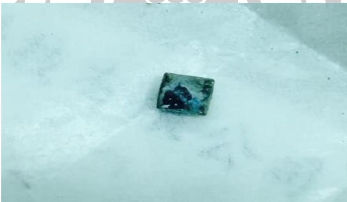
圖 4-53 反應後  $\text{CuCr}_2\text{O}_4$  觸媒吸附正丁胺後
