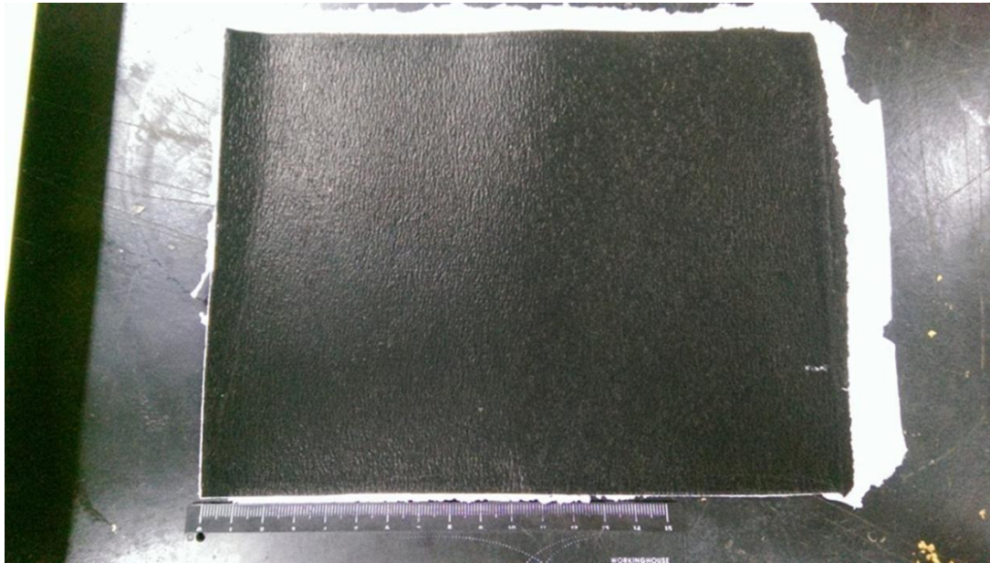
圖 4-4 抽氣過濾後，厚度為 100\mu\text{m} 的巴克紙
