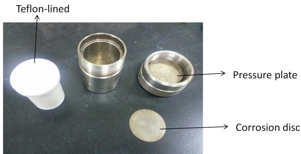
圖 1-2 Teflon 容器與不鏽鋼反應器
