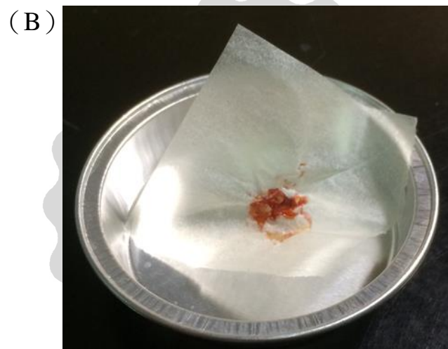
圖三十七、CS-TPP-Lycopene 奈米顆粒於加熱 ( 120^{\circ}\text{C} , 1 hr) 前 (A) 後 (B) 之顏色變化。
