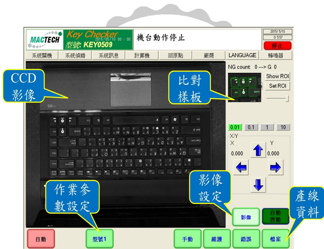
圖 4-3：智慧化產線控制及影像系統人機界面
