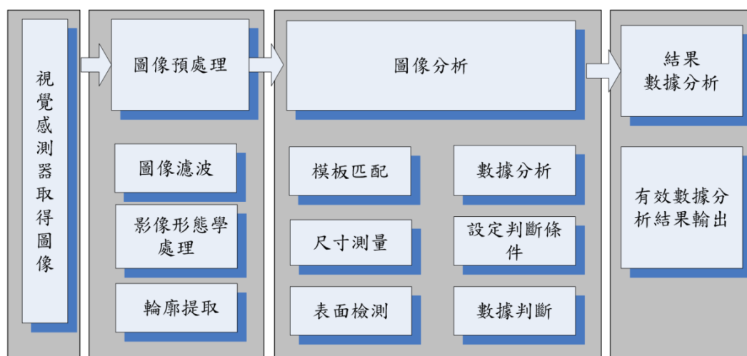
圖 3-2：影像處理技術和步驟流程
