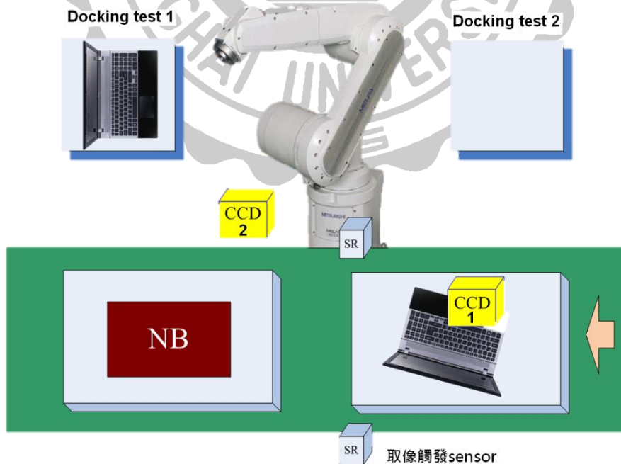
圖 4-8：筆電下方擴充基座連接器功能測試示意圖
