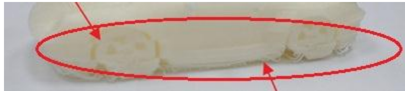
圖 2-8.缺少支柱導致失敗案例
