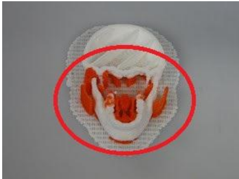
圖 2-9.支柱剷除導致失敗案例
