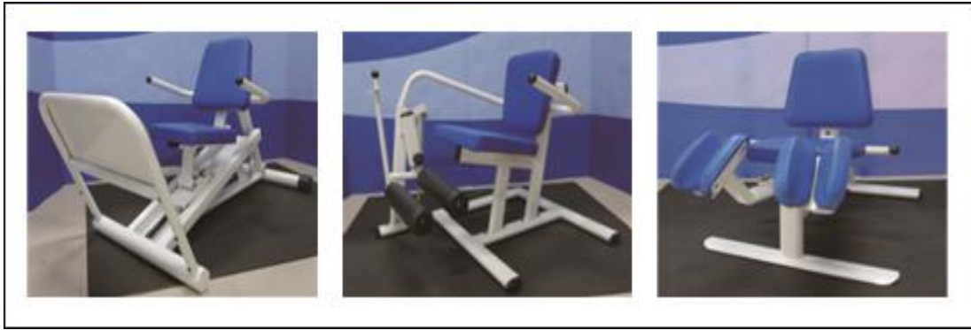
圖 4.2: 下肢輕運動機台(a)蹬腿機(b)抬腿機(c)內收外展機
