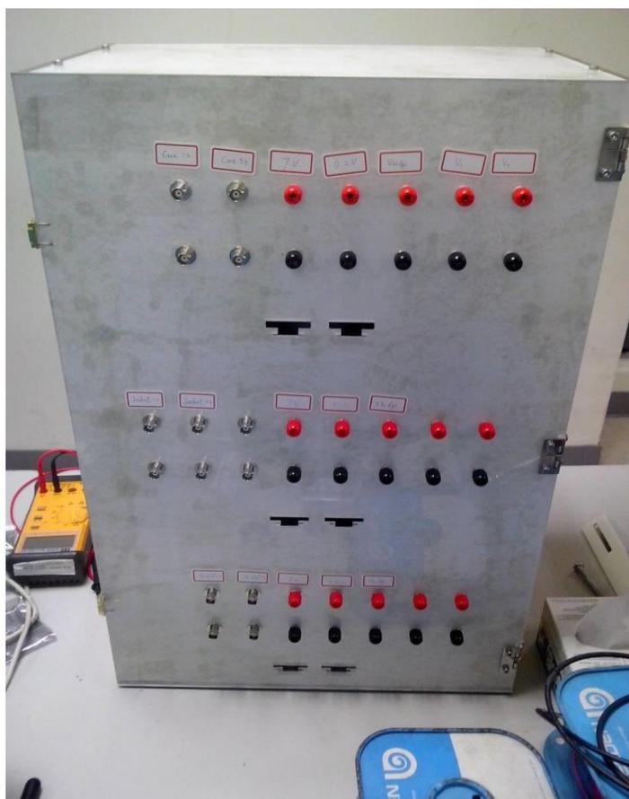
圖(2-6) 電磁屏蔽箱正面圖
