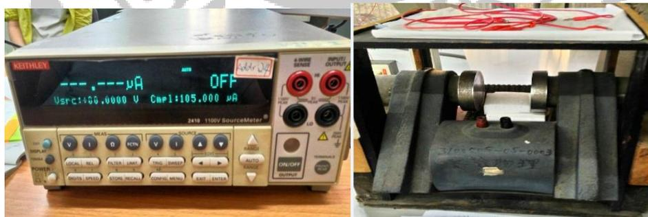
圖 3- 6 微小電流電壓量測儀(左)、電磁鐵(右)
