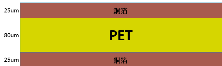
圖 34 上下夾層剖面結構圖
