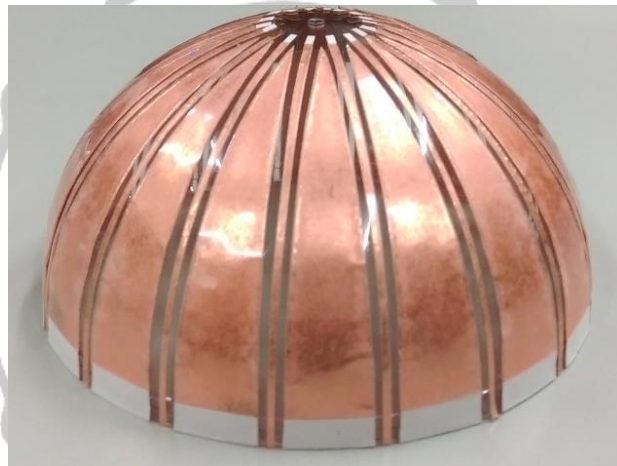
圖 53 實作的 U 型電極陣列觸控半球
