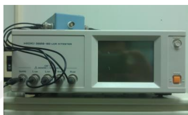
【圖 3-12】阻抗頻譜量測儀器(HIOKI 3522-50 LCR HiTESTER)。
