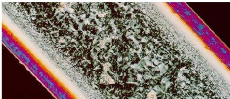
圖 3-9 聚烯烴高分子(iPP)在 injection molding process 之側面圖。[80]
